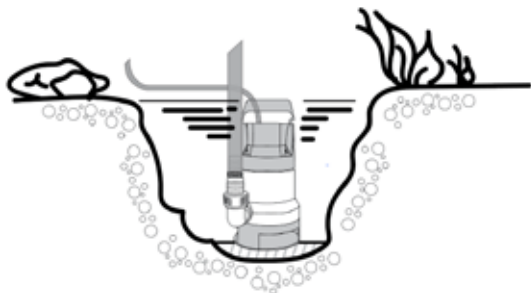
Рис. 3 Насос устанавливается на крепкую подставку
